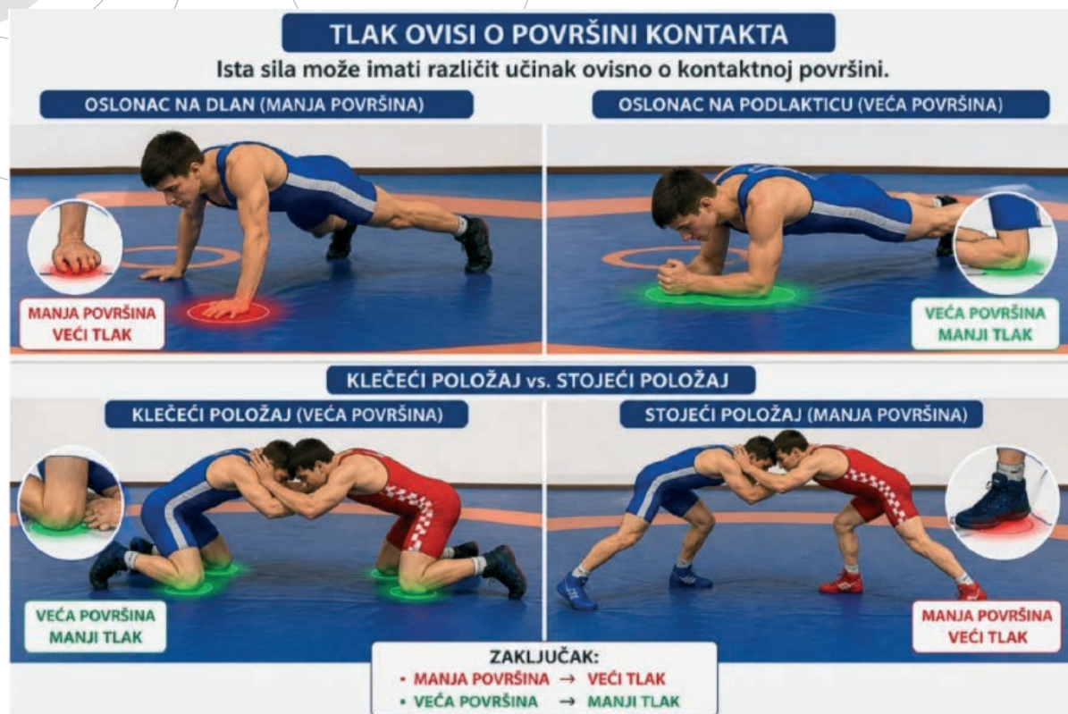
Slika 7 Tlak ovisi o površini kontakta
