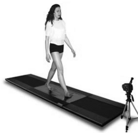
Slika 4. Platforma sila za mjerenje sile reakcije tla
